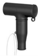
IH-A 24630, IH-A 42630 Изоляционный колпак из гибкой резины с внешним проводящим слоем и предустановленным изолирующим стержнем. Устанавливается в HDC-630 вместо кабельного разъема для того, чтобы временно изолировать вводы распределительного устройства или трансформатора на 630 А.
