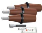
PC 630-3 L Переходник для параллельного соединения. Заменяет перемычку в CSE-A при параллельном подсоединении к другому CSE-A на напряжение 36 кВ.
